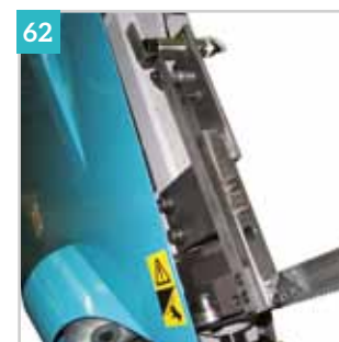
58 000947 Sistema lubrificação mínima 1.3 litros
