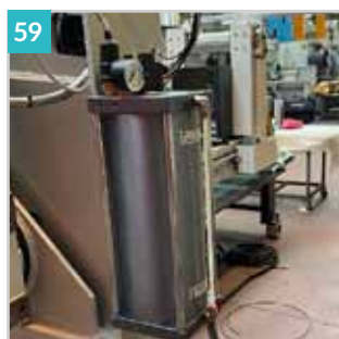
59 000947 Sistema lubrificação mínima 1.3 litros
