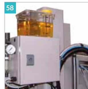
58 000947 Sistema lubrificação mínima 1.3 litros
